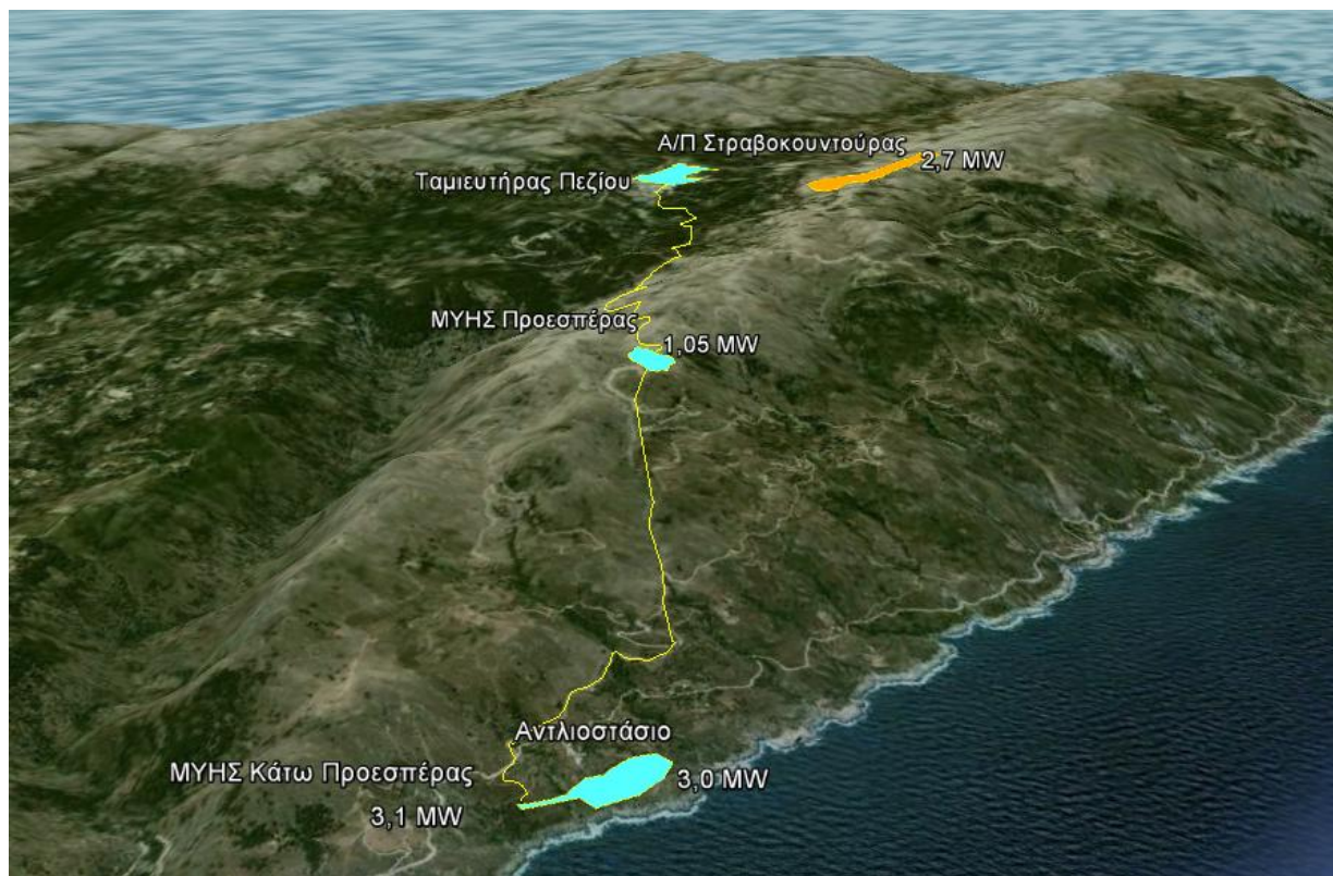
Εικόνα 4.4: Βασικές μονάδες του Υβριδικού Αντλιοσταμειωτικού Σταθμού της Ικαρίας
